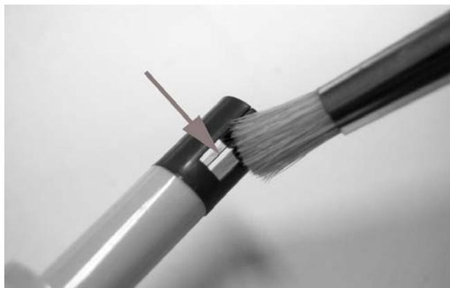
Figura 8b: limpieza del caudalímetro
