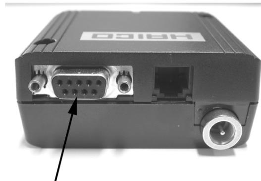
**Figura 24: conexión del cable de datos**
