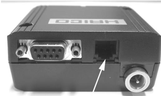
**Figura 27: Conexión de la fuente de alimentación**
