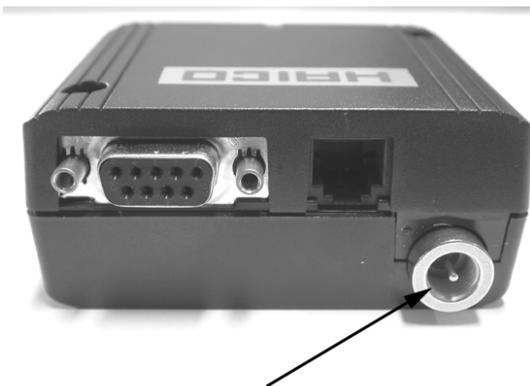
**Figura 23: conexión de la antena**
